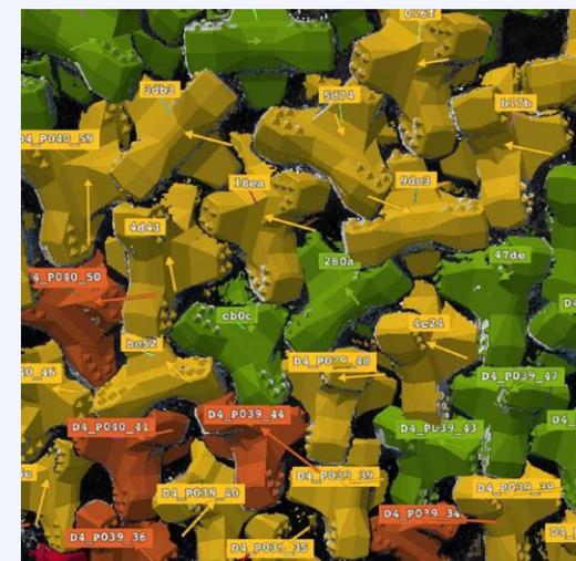
Visualisation des mouvements de la digue bloc par bloc
